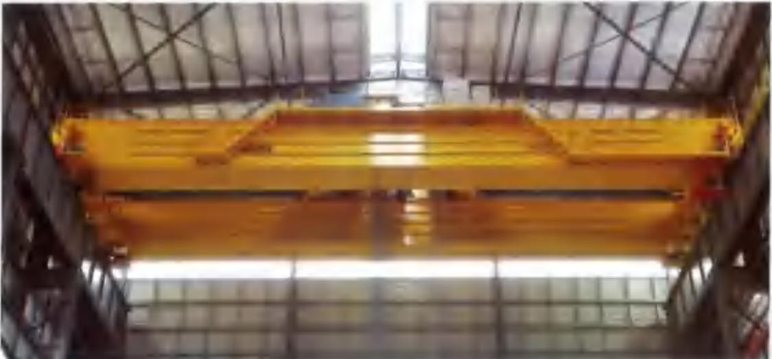
江苏宏宝精密机械制造有限公司用KSSQ型250吨新型双梁桥式起重机
