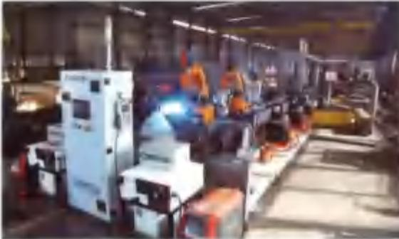
单梁机器人自动化焊接流水线
