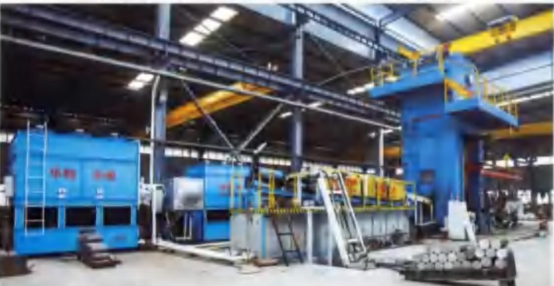
车轮锻造碾压复合工艺智能化流水线
